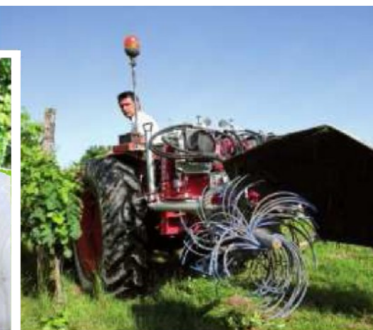
CHAQUE TÊTE comporte cinquante-deux fils. Ils sont régulièrement renouvelés, ceux de l'arrière toutes les deux heures et à l'avant toutes les quatre heures. La bobine de 120 mètres coûte dix euros.
