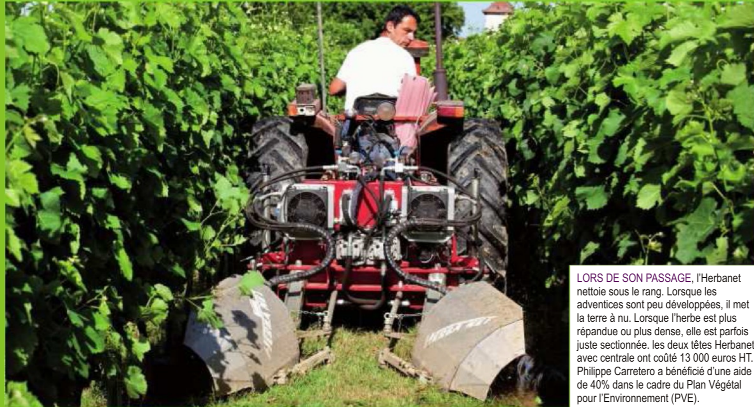
Philippe CARRETERO nettoie une bande de 20 cm de large sous le rang avec l'Herbanet depuis un an. Il est satisfait du résultat obtenu : la bande est parfaitement désherbée.
